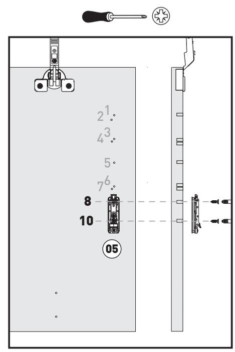
SYSTÈME DE FIXATION SUR LE CÔTÉ DU CAISSON
