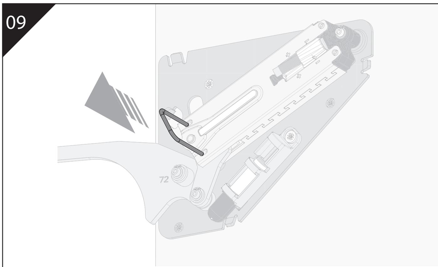
AJUSTEZ LA FORCE DU SYSTÈME À L'AIDE D'UN EMBOUT TORX T20
