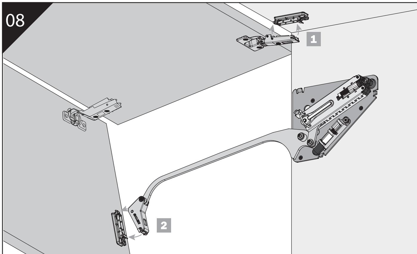
RETIREZ LE CLIP DE SÉCURITÉ: FERMEZ LÉGÈREMENT LES PORTES ET RETIREZ LES CLIPS DE SÉCURITÉ
