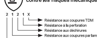
Le pictogramme ci-dessus indique que ce gant protège contre les risques mécaniques conformément à la norme EN388:2016+A1:2018.
