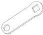
F04 LINKAGE STRAP - A4M02225 (x1) 1/8"x13/16"x2 5/8" (3x20x66)
