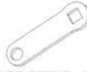
F04 LINKAGE STRAP - A4M02225 (x1) 1/8"x13/16"x2 5/8" (3x20x66)
