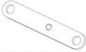
F03 LINKAGE STRAP - A4M02229 (x1) 1/2"x11/16"x3 13/16" (13x17x97)
