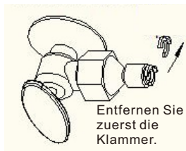
SCHRITT 2: Schrauben Sie den Schnellverbinder mit dem Gewinde auf den Wasserhahn und entfernen Sie die Klammer.
